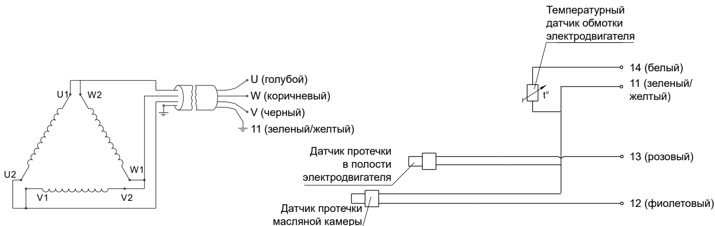
Схема подключения погружных канализационных насосов WQ/ES (треугольник)
